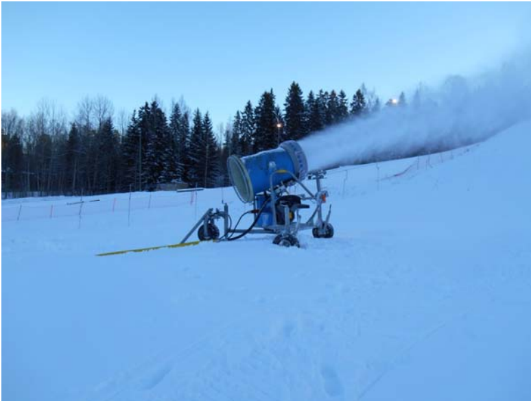
Kuva 2. Vuoden 2016 mittauksen aikana rinteän yläosassa ollut puhallinlumitykki (kuva 5.1.2017).
